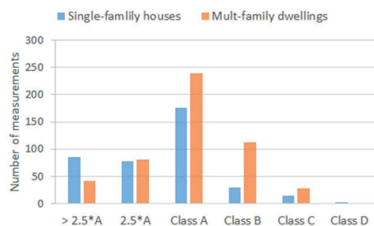
Abbildung 3: Verteilung der durch Messungen ermittelten Dichtheitsklassen von Luftleitsystemen in Wohnbauten [11]
